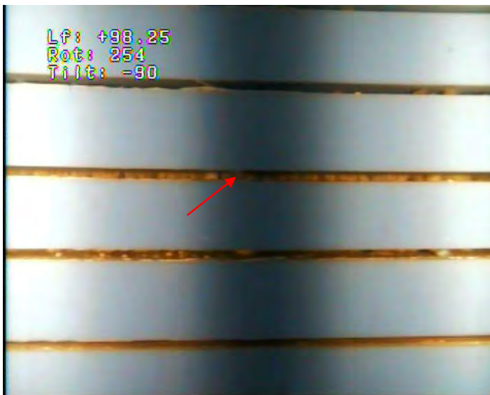
93 – Crépine PVC en Ø 263/273 mm – Crépines bien ouvertes
