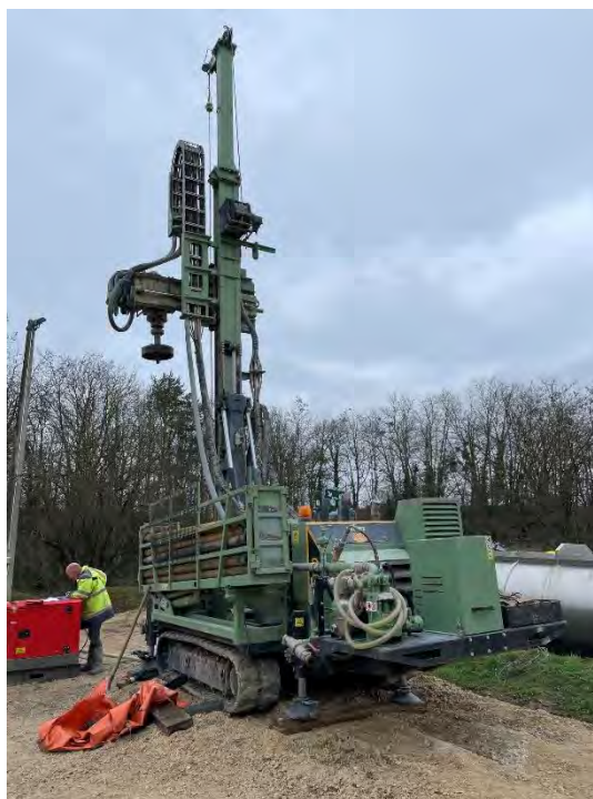
Figure 6 : Atelier de servicing – Nettoyage et pompages d'essais sur le forage de SECM (18/01 au 30/01/2024)
