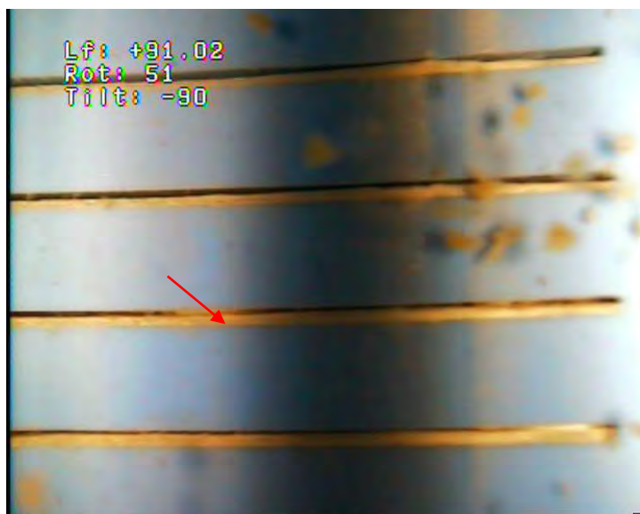
83 – Crépine PVC en Ø 263/273 mm – Crépines partiellement colmatées
